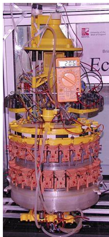
Joonis 2. EcoBot III MKEdel põhinev autonoomne robot (allikas: Wikipedia)
