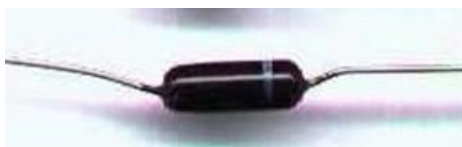
Eine Diode mit einem Streifen, der die negative Kathode kennzeichnet. So weiß man, wie sie in einen Schaltkreis einzufügen ist. (Quelle: Public Domain Wikipedia)
