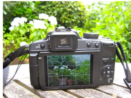
Abbildung 1 und 2: eine Digitalkamera mit 24-fachem optischen Zoom und 14 Megapixel (Quelle: KHLim)
