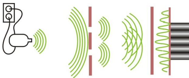
Abbildung 1 Die Quantenfeldtheorie geht davon aus, dass ein Feld mit Teilchen wie einem Elektron verbunden ist. Das Feld passiert den Spalt und überlagert sich (konstruktiv und destruktiv) an unterschiedlichen Stellen. Dort wo die Amplituden groß sind, besteht eine gute Chance, dass vom Feld ein diskretes und lokales Energiepaket abgegeben wird. Dieses beobachten wir als ein Teilchen.
